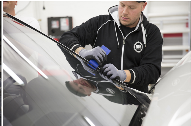
Demontering av pyntelist.
