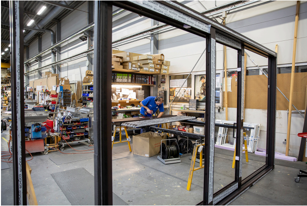
Produksjon av skyvedør.
