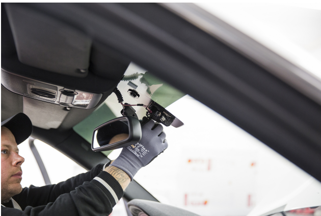
Demontering av kamera.
