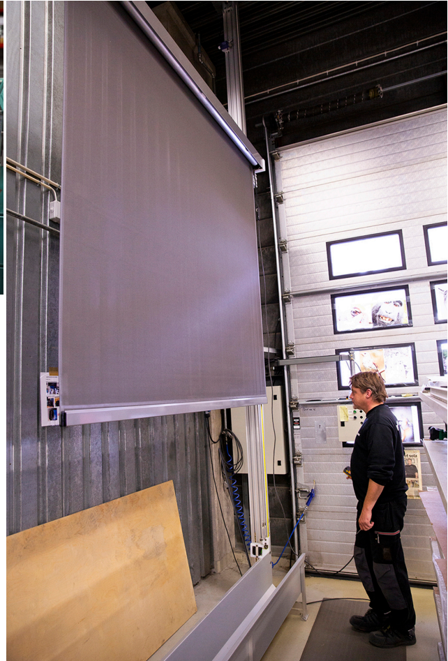
Test og kontroll av utvendig screen før pakking.
