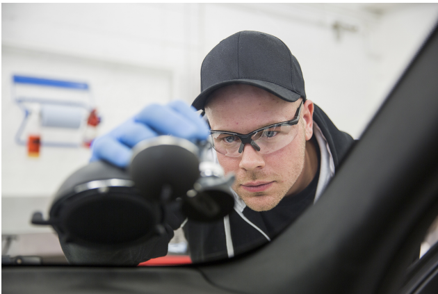
Tilføring av resin.
